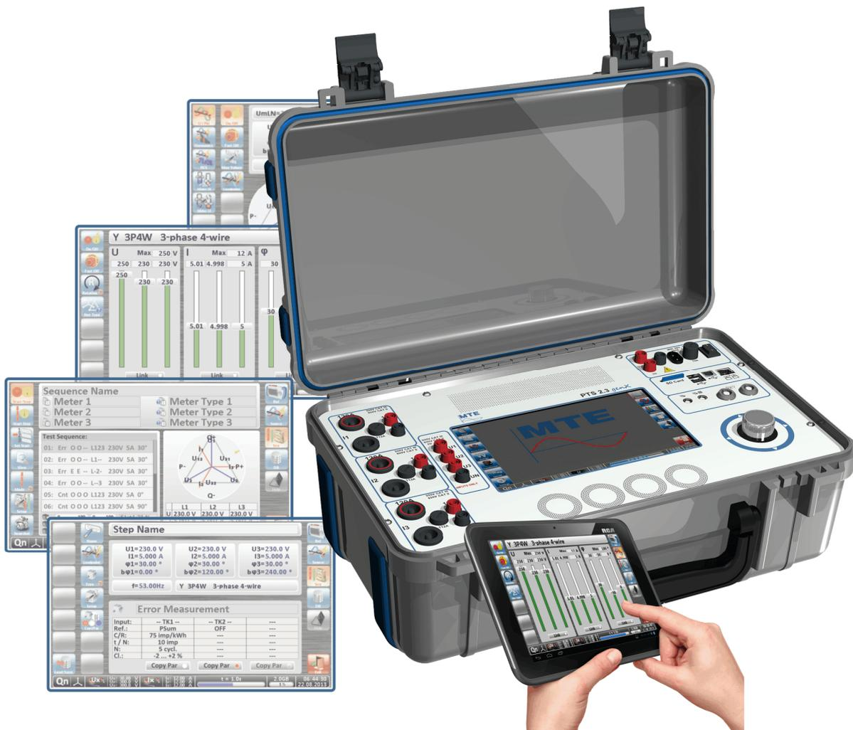
Le système de mesure portable PTS 2.3 genX comprend un générateur de courant triphasé, ainsi qu'un compteur étalon de classe 0.1. Les caractéristiques du PTS 2.3 genX sont sa large plage de mesure, sa haute précision et sa grande tolérance aux influences extérieures indésirables. Le PTS 2.3 genX permet de vérifier l'ensemble des composants d'une installation de comptage moderne, ainsi que l'analyse du réseau local.
